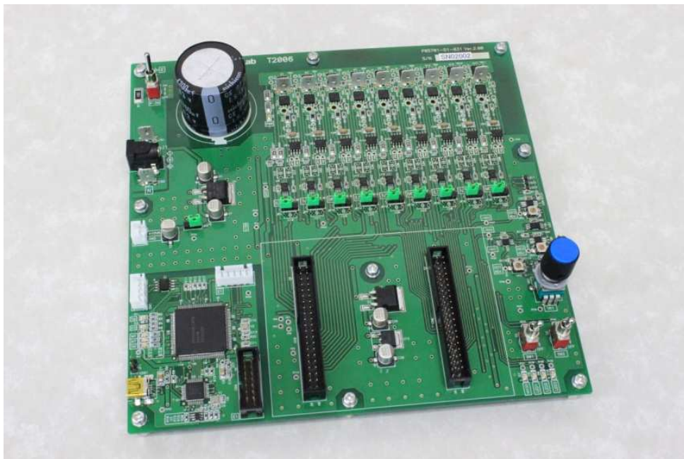
図 3 T2006A 低電圧インバータ (三相インバータ 3ポート版)
