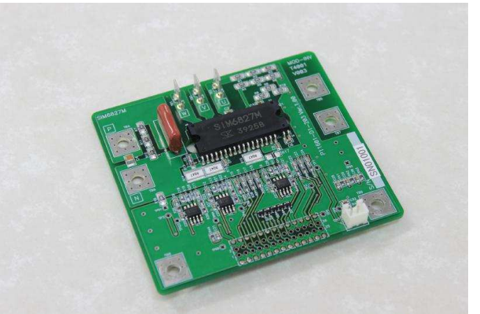
T4001-V003 (サンケン SIM6827M 使用モジュール)
