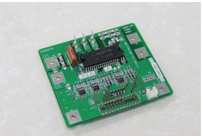
T4001-V003 (サンケン SIM6827M 使用モジュール)
